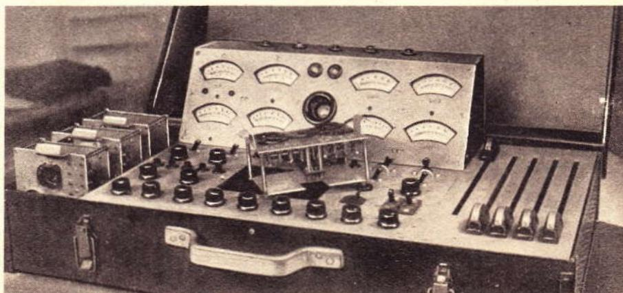
der Röhrensockel: sie sind, zu kleinen Gruppen zusammengefaßt, auf auswechselbaren Adaptern untergebracht, so daß dieses Gerät völlig „zukunftsicher“ ist. Eine spätere Beschreibung wird auf die Einzelheiten dieser bemerkenswerten Konstruktion näher eingehen.
