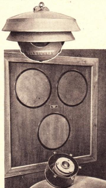
Rechts oben: Schallinglautsprecher „Ela L 0710“ mit einer Gesamtbelastung von 30 W, die von den eingebauten 5 parallel geschalteten perm.-dyn. 6 W-Chassis geliefert werden. Rechts: Drei-Lautsprecher-Kombination und (darunter) der neue Hochtonlautsprecher mit schwenkbarem System zur Einstellung der Abstrahlrichtung
